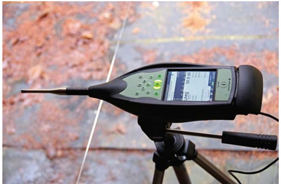
**Ein Teil der erprobten Flüstertüten. Insgesamt wurden 37 Schalldämpfer getestet. Mit diesem Klasse-1-Schallpegel-Messgerät Brüel & Kjær 2250 wurden die Messungen durchgeführt.**
